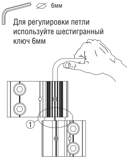
Регулировка зазора между рамой и створкой ( \pm 3 мм)
