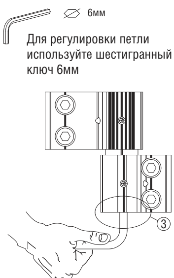
Регулировка по-высоте (+4 мм; - 1 мм)
